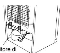
Containitore di evaporazione
